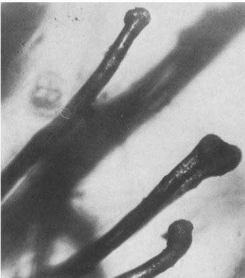
Abb. 7. Schmelzköpfchen am Rand eines Einschusses. Schußentfernung: 4 m. Material: Nylon. Waffe: Smith & Wesson Kal. 38. Vergr.: 1 : 320 Durchlicht
